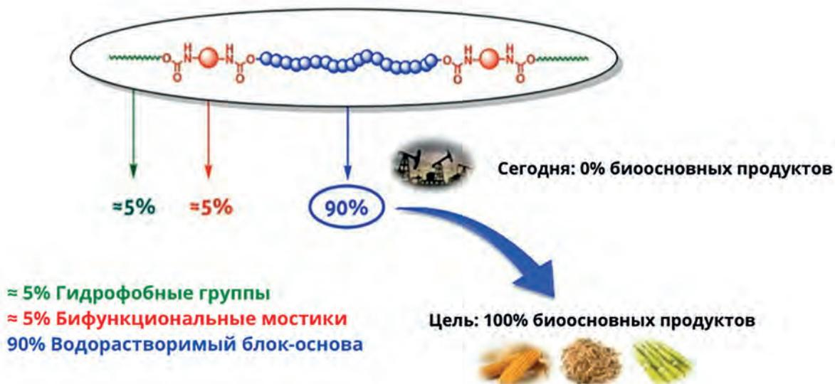
Обычно они состоят из 3 различных химических соединений. В среднем блоке (синего цвета), который обычно составляет 90% модификатора реологии, находится водорастворимая часть. Это ключевой строительный блок. В красном цвете — бифункциональные мостики, которые показывают, какие химические связи там используются. Зеленые блоки (завершают цепочку) — гидрофобные группы, которые взаимодействуют со связующими и пигментами, именно они отвечают за эффект загущения.
